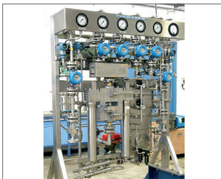
Estação de filtração de gases com válvulas de esfera de comando de 3 vias STAUFF para 250 bar / 3600 PSI e +200 °C / +392 °F.
