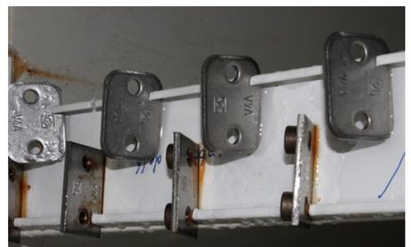
Ensaios na câmara de névoa salina com acessórios de fixação ACT (acima na imagem) comparativamente com peças em aço inoxidável convencionais V4A (abaixo na imagem).
