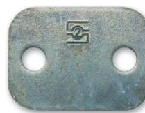
Placa de cobertura STAUFF original revestida a zinco/níquel: Sem sinais de corrosão após 528 horas na câmara de névoa salina!
