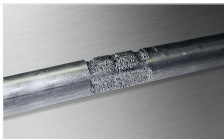
Corrosão por fendas num corpo de abraçadeira convencional
