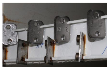
Ensaios na câmara de névoa salina com acessórios de fixação ACT (acima na imagem) comparativamente com peças em aço inoxidável convencionais V4A (abaixo na imagem).
