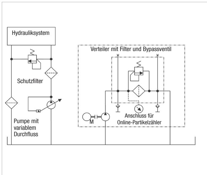
**Bypass-Filter BPS Hydraulisches Symbol**
