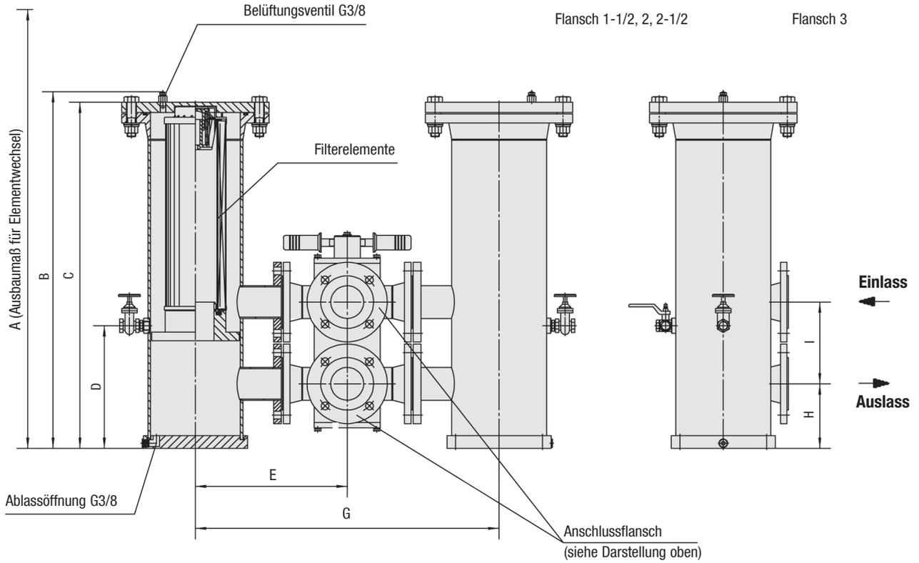
Anordnung der Filterelemente
