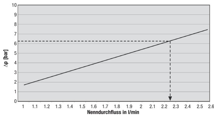
**Durchfluss-Diagramm BPS-Filter mit Filterelement SRM-30-H-B (bei maximaler Viskosität)**
