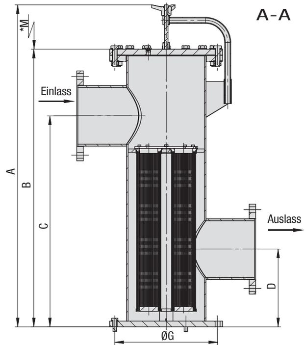
**Anordnung der Filterelemente**
