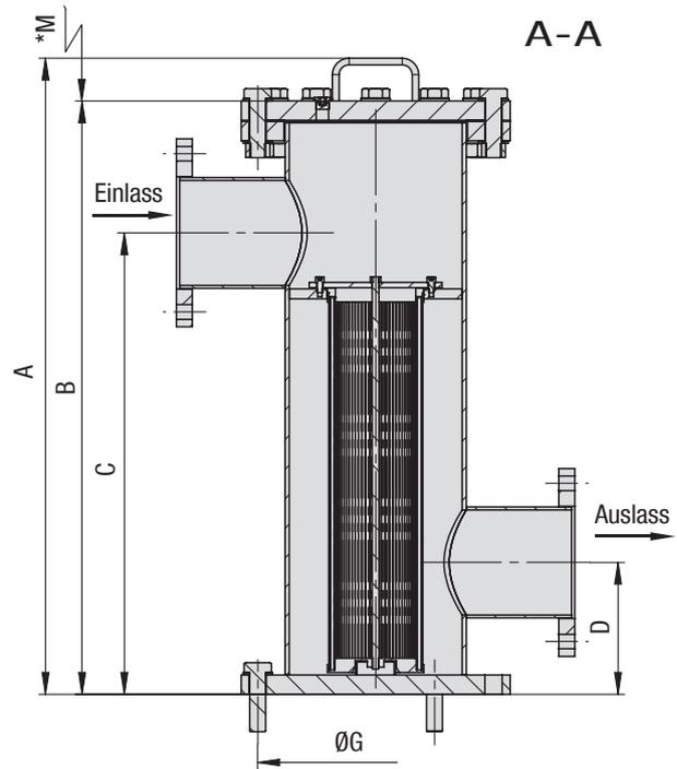
Anordnung der Filterelemente
