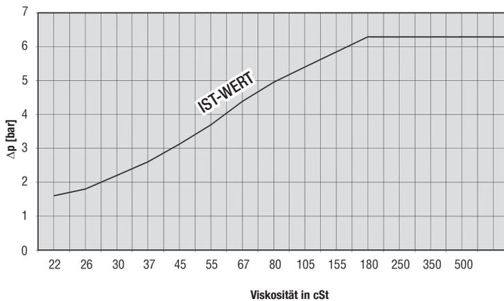
**Durchfluss-Diagramm OLS-Filter mit Filterelement SRM-30-H-B (bei maximaler Viskosität)**
