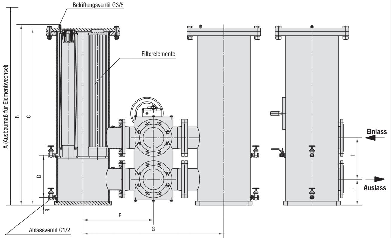
Anordnung der Filterelemente
