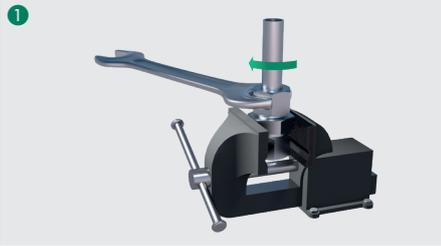
Ziehen Sie die Überwurfmutter bis zum Punkt des deutlich spürbaren Kraftanstiegs an (Druckpunkt). Ab diesem Punkt kann das Rohr nicht mehr in der Verschraubung gedreht werden.
