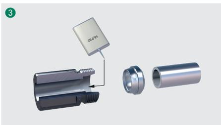
3 Benetzen Sie den 24°-Konus des Montagestutzens leicht (z.B. mit Hydrauliköl HLP32). Verwenden Sie kein Schmierfett!
