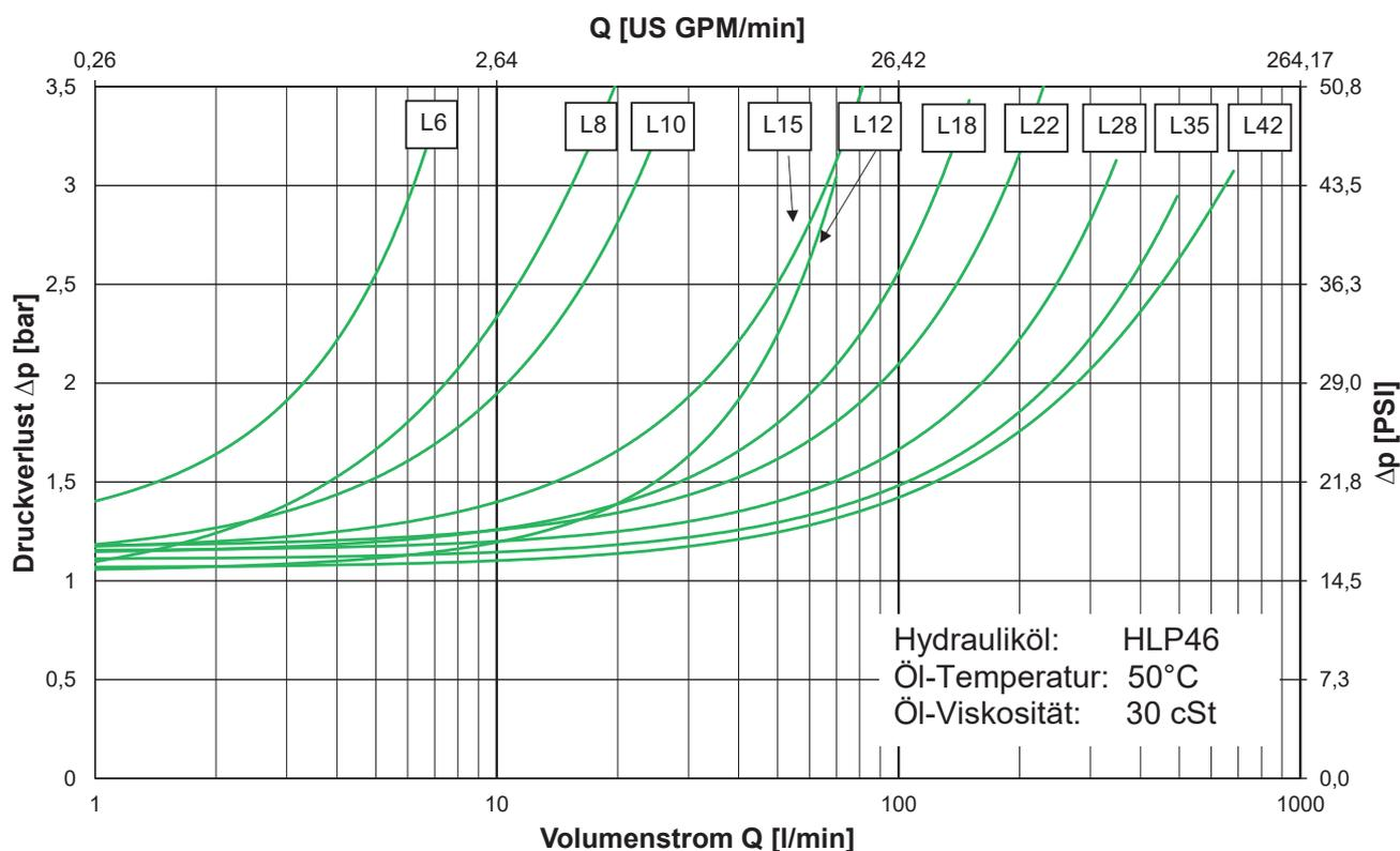
**Druckverlustkurven: Rückschlagventile, Öffnungsdruck 1 bar S-Reihe**
