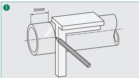
Sägen Sie das Rohrende in einem rechten Winkel (90°) und mindestens 10 mm entfernt vom Trennschnitt des Herstellers / Lieferanten ab.
