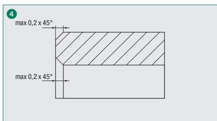
Entgraten Sie die Innen- und Außenseite des Rohrendes leicht (max 0,2 x 45°). Reinigen Sie den Montagebereich des Rohres von etwaigen Verschmutzungen, Späne und Farbresten.
