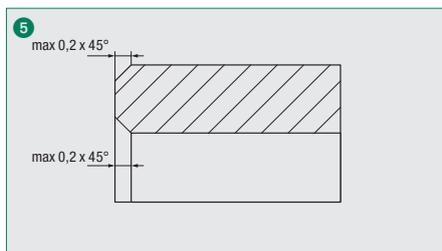
Entgraten Sie die Innen- und Außenseite des Rohrendes leicht (max 0,2 x 45°). Reinigen Sie den Montagebereich des Rohres von etwaigen Verschmutzungen, Späne und Farbresten.
