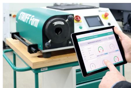
Rohrformmaschinen des Typs SFO-F-A-A sind werkseitig mit einem eingebauten Modul zur direkten Anbindung an eine von STAUFF betriebene Cloud ausgerüstet. Realisiert wird diese Lösung mit einer integrierten SIM-Karte, die in sämtlichen Industrieregionen der Welt genutzt werden kann.
