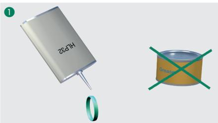
Dichtring innen und außen leicht einölen (z.B. mit Hydrauliköl HLP32). Verwenden Sie kein Schmierfett!
