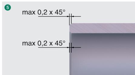
5 Entgraten Sie die Innen- und Außenseite des Rohrendes leicht (max  $0,2 \times 45^\circ$ ). Reinigen Sie den Montagebereich des Rohres von etwaigen Verschmutzungen, Späne und Farbresten.
