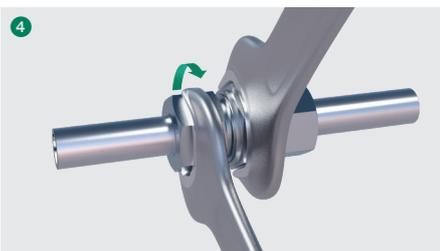
Überwurfmutter mit einem kurz gefassten Gabelschlüssel bis zum Punkt des deutlich spürbaren Kraftanstiegs (Festpunkt) anziehen.
