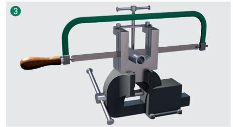
3 Bitte verwenden Sie keine Rohrschneider oder Trennschleifer.
