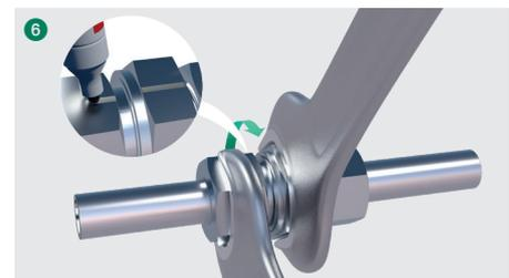
Eine Markierungslinie auf der Überwurfmutter und dem Verschraubungskörper erleichtert die Beachtung und Überprüfung des korrekten Anzugswinkels.
