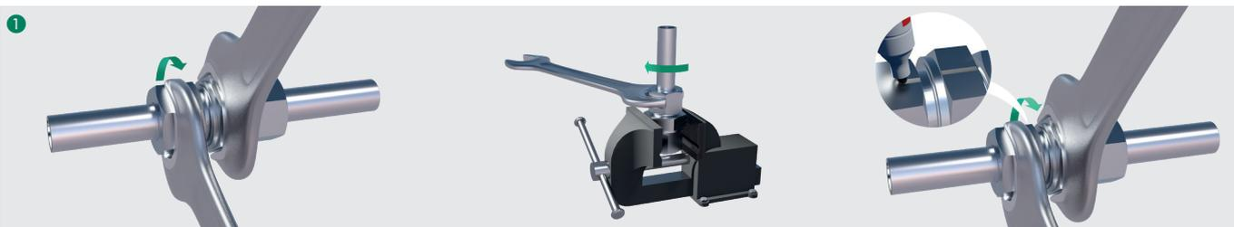
Bitte beachten Sie bei Verwendung von FI-WDD5-W5 mit Edelstahlverschraubungen: Gewinde und 45°-Konus an Überwurfmutter sowie Gewinde des Verschraubungsstutzens mit Edelstahl-Montagepaste ausreichend einfetten oder eine versilberte Überwurfmutter verwenden.
