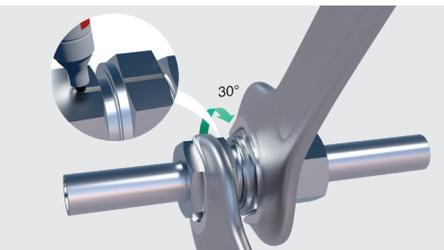
Eine Markierungslinie auf der Überwurfmutter und dem Verschraubungskörper erleichtert die Beachtung und Überprüfung des korrekten Anzugswinkels.
