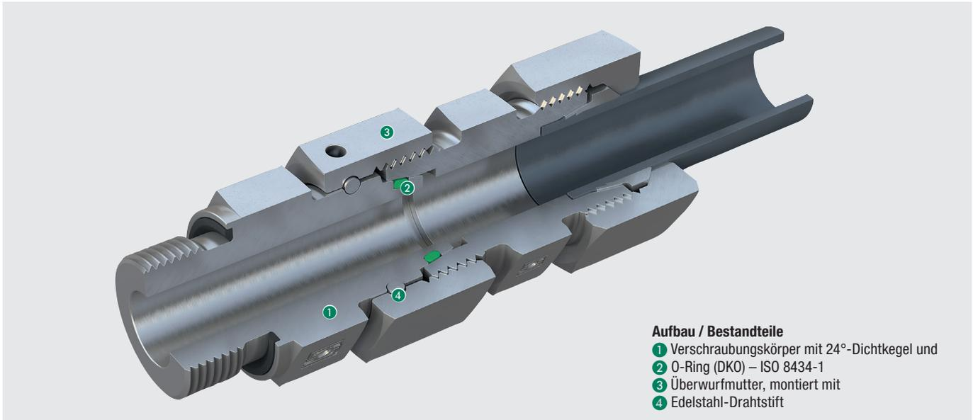
Durch die an den Verschraubungskörpern angeordneten 24°-Dichtkegel mit O-Ring stellen STAUFF Connect DKO-Rohrverschraubungen eine sinnvolle Weiterentwicklung von traditionell verfügbaren Rohrverschraubungen mit Rohransatz und vormontierten Schneidringen und Überwurfmutter dar.
