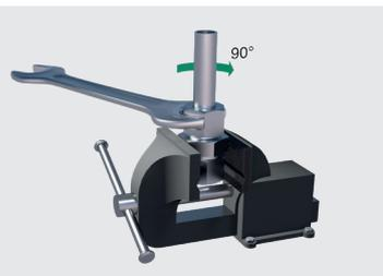
Verwenden Sie einen geeigneten Gabelschlüssel, um den Verschraubungskörper während der Montage gegenzuhalten. Für den Fall ungünstiger Montagebedingungen oder großen Rohrabmessungen empfiehlt sich die Montage im Schraubstock.
