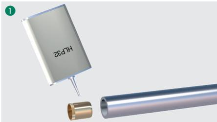
Benetzen Sie die Außenseite der Verstärkungshülse leicht (z.B. mit Hydrauliköl HLP32).
