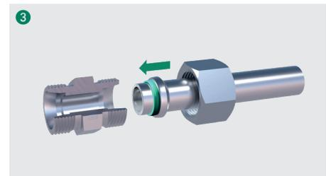
Rohrende mit aufgestecktem Dichtring vorsichtig in den 24°-Konus des Verschraubungskörpers einschieben.
