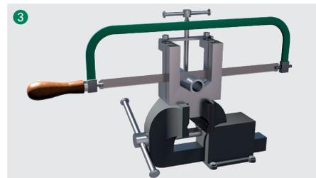
3 Bitte verwenden Sie keine Rohrschneider oder Trennschleifer.
