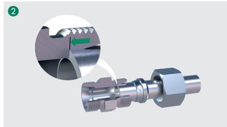
2 Schieben Sie das Rohrende vorsichtig in den 24°-Konus des Verschraubungskörpers, bis dieses bündig am Anschlag anliegt.
