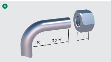
4 Die Länge der geraden Rohrenden von Rohrbögen muss mindestens der doppelten Länge der Überwurfmutter entsprechen.
