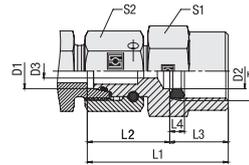
**Whitworth Rohringengewinde (zylindrisch)**
