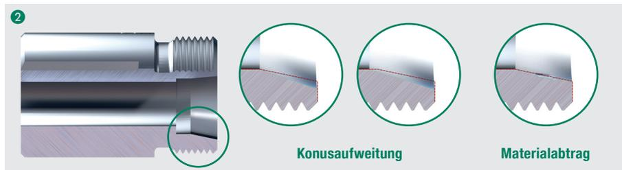
Montagestutzen sollten regelmäßig auf Beschädigungen und Maßhaltigkeit überprüft werden. Beschädigte und nicht maßhaltige Montagestutzen sind zwingend auszutauschen.
