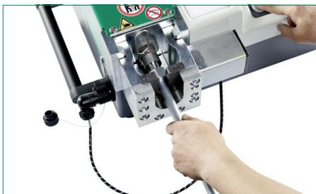
Werkzeugkopf zur Schneidring-Montage mit automatischer Druckeinstellung / Größenerkennung
