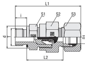
Durchflussrichtung: B > A (zum Stutzen)
