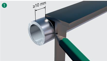
Sägen Sie das Rohrende in einem rechten Winkel (90°) und mindestens 10 mm entfernt vom Trennschnitt des Herstellers / Lieferanten ab.
