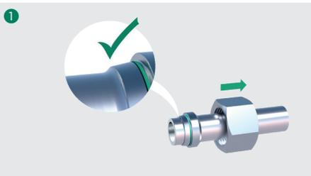
Lösen Sie die Überwurfmutter vollständig, um das Montageergebnis visuell zu überprüfen. Vor dem Schneidring muss ein deutlicher Materialaufwurf erkennbar sein und sollte die Schneidenstirnfläche mit ca. 80% bedecken.
