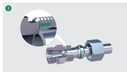
Schieben Sie das Rohrende vorsichtig in den 24°-Konus des Verschraubungskörpers, bis dieses bündig am Anschlag anliegt.
