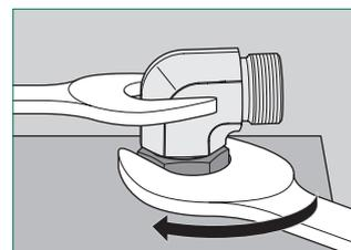
Ziehen Sie die Kontermutter nach vorgegebenem Drehmoment (siehe S. 171-179) fest, halten Sie dabei den Verschraubungskörper mit einem Schraubenschlüssel in Einstellrichtung gegen.
