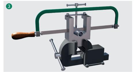
Bitte verwenden Sie keine Rohrschneider oder Trennschleifer.
