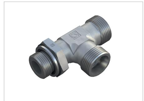
Einschraubstutzen wurden ausgelegt für Einschraublöcher in Bauteilen aus Stahl. Für den Einsatz in Verbindung mit Bauteilen aus weichen Gegenwerkstoffen (z.B. Aluminium) wird die Verwendung von Verschraubungen mit zusätzlich nachgerollten Aussengewinden empfohlen. Bitte wenden Sie sich für weitere Informationen rechtzeitig vor Anwendung an STAUFF.
