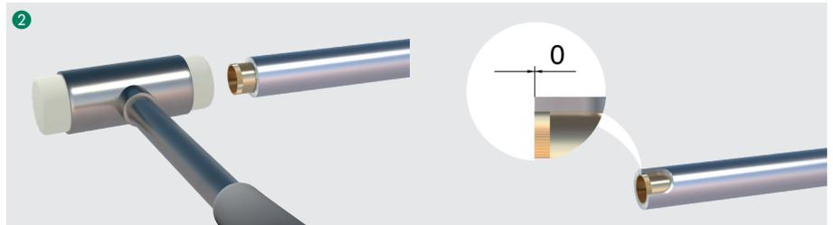
Schlagen Sie die Verstärkungshülse mit einem Hartgummi- oder Kunststoffhammer vollständig in das Rohrende ein.
