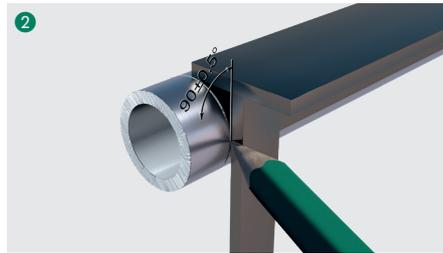
2 Die maximal zulässige Winkelabweichung beträgt  $\pm 0,5^\circ$  zur Rohrachse.
