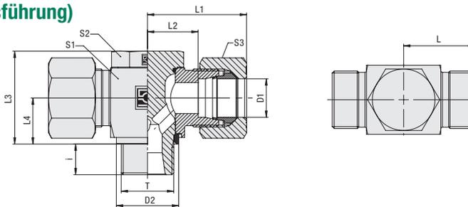
**Whitworth Rohrgewinde (zylindrisch)**
