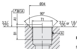
**Einschraubblock (Zylindrisches Gewinde)**
