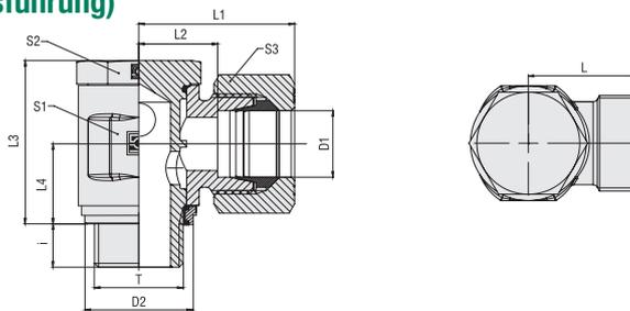
**Whitworth Rohrgewinde (zylindrisch)**
