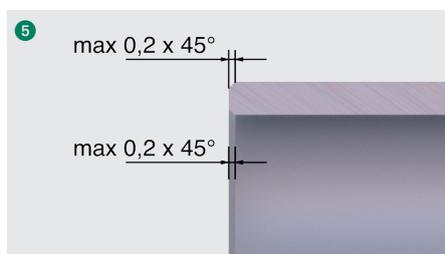
5 Entgraten Sie die Innen- und Außenseite des Rohrendes leicht ( $\max 0,2 \times 45^\circ$ ). Reinigen Sie den Montagebereich des Rohres von etwaigen Verschmutzungen, Späne und Farbresten.
