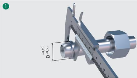
Kontrolldurchmesser D des umgeformten Rohrendes anhand der nebenstehenden Maßtabelle mit einem geeigneten Messmittel (Messschieber) überprüfen.
