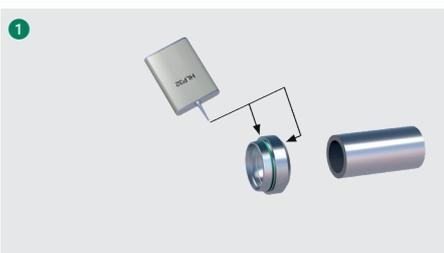
Bitte beachten Sie bei Verwendung von FI-WDDS-W5 mit Edelstahlverschraubungen: Gewinde und 45°-Konus an Überwurfmutter sowie Gewinde des Verschraubungsstutzens mit Edelstahl-Montagepaste ausreichend einfetten oder eine versilberte Überwurfmutter verwenden.
