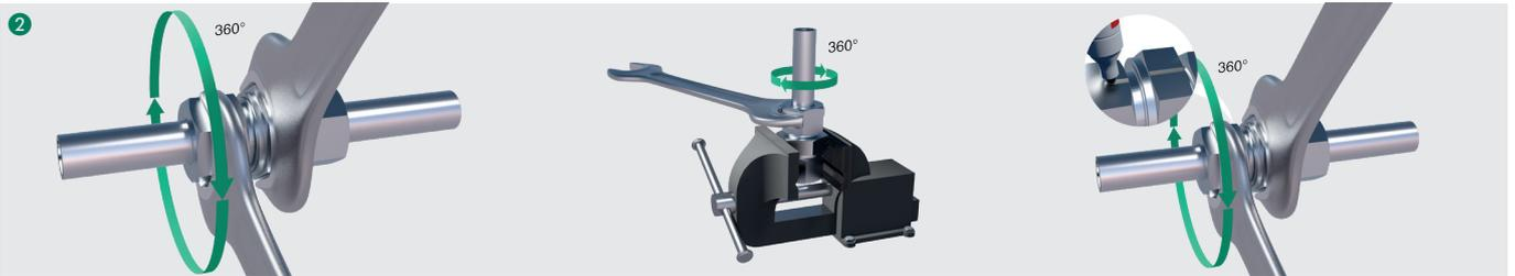
Verwenden Sie einen geeigneten Gabelschlüssel, um die Überwurfmutter um eine weitere volle Umdrehung (360°) über den Druckpunkt hinaus anzuziehen.
