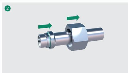
Benetzen Sie die beiden weichdichtenden Elemente des Schneidrings leicht (z.B. mit Hydrauliköl HLP32). Verwenden Sie kein Schmierfett!
