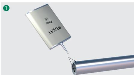
Benetzen Sie die Innen- und Außenseite des Rohrendes leicht (z.B. mit einem dünnen Film aus Hydrauliköl HLP32), bevor Sie den maschinellen Umformvorgang starten. Verwenden Sie kein Schmierfett!
