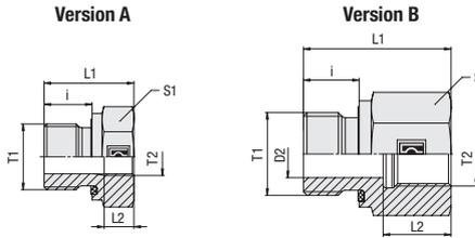
**Whitworth Rohrgewinde / -Rohrinnengewinde (zylindrisch)**
