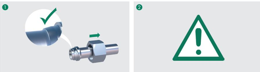
Lösen Sie die Überwurfmutter vollständig, um das Montageergebnis visuell zu überprüfen. Vor dem Schneidring muss ein deutlicher Materialaufwurf erkennbar sein und sollte die Schneidenstirnfläche fast vollständig bedecken. Unter Umständen ist es zu diesem Zeitpunkt noch möglich, den Schneidring auf dem Rohr (radial) zu drehen. Er lässt sich allerdings nicht mehr in Rohrrichtung (axial) verschieben.
