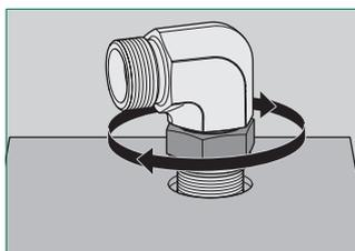
Schrauben Sie den Verschraubungskörper vollständig ein.
