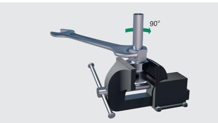
Verwenden Sie einen geeigneten Gabelschlüssel, um den Verschraubungskörper während der Montage gegenzuhalten. Für den Fall ungünstiger Montagebedingungen oder großen Rohrabmessungen empfiehlt sich die Montage im Schraubstock.
