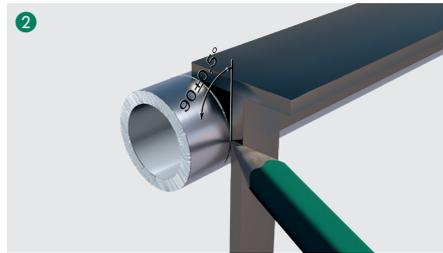
Die maximal zulässige Winkelabweichung beträgt  $\pm 0,5^\circ$  zur Rohrachse.
