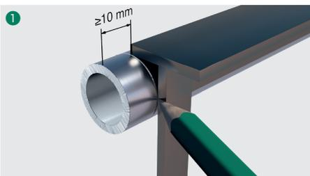
1 Sagen Sie das Rohrende in einem rechten Winkel (90°) und mindestens 10 mm entfernt vom Trennschnitt des Herstellers / Lieferanten ab.
