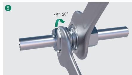
Montage durch Anzug der Überwurfmutter mit einem Drehwinkel von 15°-20° über den Festpunkt hinaus abschließen. Während der gesamten Montage den Verschraubungskörper mit einem zweiten geeigneten Gabelschlüssel gehalten.
