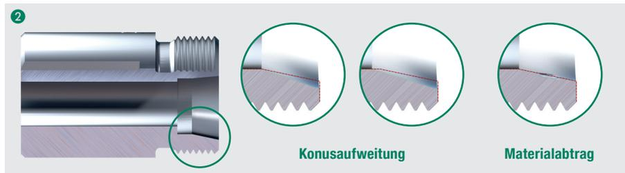
2 Montagestutzen sollten regelmäßig auf Beschädigungen und Maßhaltigkeit überprüft werden. Beschädigte und nicht maßhaltige Montagestutzen sind zwingend auszutauschen.
