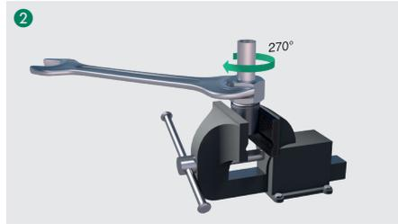
Verwenden Sie einen geeigneten Gabelschlüssel, um die Überwurfmutter um eine weitere 3/4-Umdrehung (270°) über den Druckpunkt hinaus anzuziehen.
