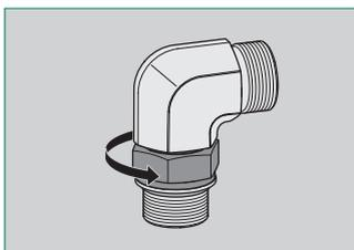
Benetzen Sie den O-Ring (z.B. mit Hydrauliköl HLP32). Verwenden Sie kein Schmierfett!
