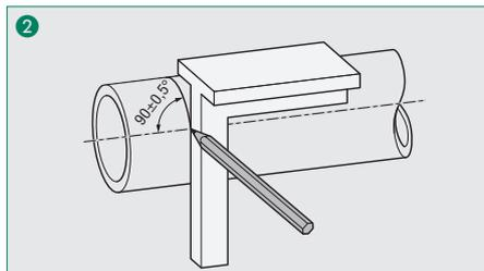
Die maximal zulässige Winkelabweichung beträgt  $\pm 0,5^\circ$  zur Rohrachse.
