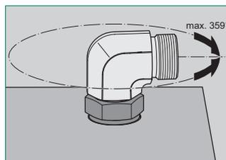
Stellen Sie die Richtung ein. Achtung: Maximal eine Umdrehung gegen die Einschraubrichtung zurückdrehen!
