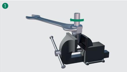
Ziehen Sie die Überwurfmutter bis zum Punkt des deutlich spürbaren Kraftanstiegs an (Druckpunkt). Ab diesem Punkt kann das Rohr nicht mehr in der Verschraubung gedreht werden.
