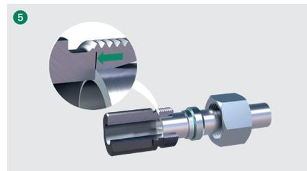
Bitte beachten Sie bei Verwendung von FI-WDDS-W5 mit Edelstahlverschraubungen: Gewinde und 45°-Konus an Überwurfmutter sowie Gewinde des Verschraubungsstutzens mit Edelstahl-Montagepaste ausreichend einfetten oder eine versilberte Überwurfmutter verwenden.
