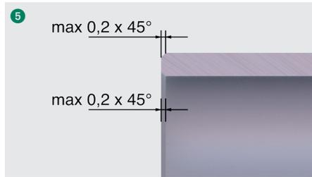
Entgraten Sie die Innen- und Außenseite des Rohrendes leicht (max  $0,2 \times 45^\circ$ ). Reinigen Sie den Montagebereich des Rohres von etwaigen Verschmutzungen, Späne und Farbresten.
