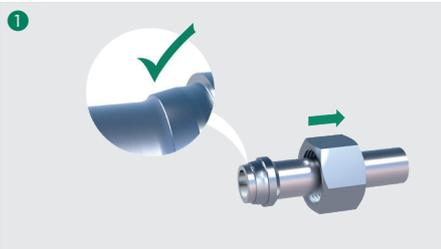
Lösen Sie die Überwurfmutter vollständig, um das Montageergebnis visuell zu überprüfen. Vor dem Schneidring muss ein deutlicher Materialaufwurf erkennbar sein und sollte die Schneidenstirnfläche fast vollständig bedecken. Unter Umständen ist es zu diesem Zeitpunkt noch möglich, den Schneidring auf dem Rohr (radial) zu drehen. Er lässt sich allerdings nicht mehr in Rohrrichtung (axial) verschieben.
