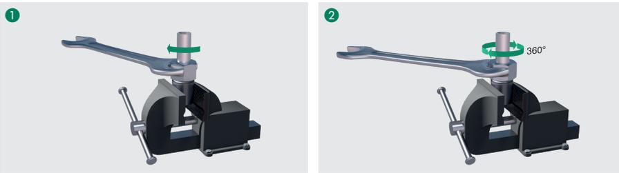
Ziehen Sie die Überwurfmutter bis zum Punkt des deutlich spürbaren Kraftanstiegs an (Druckpunkt). Ab diesem Punkt kann das Rohr nicht mehr in der Verschraubung gedreht werden.
