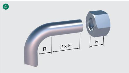
Die Länge der geraden Rohrenden von Rohrbögen muss mindestens der doppelten Länge der Überwurfmutter entsprechen.
