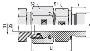
Whitworth Rohrgewinde (zylindrisch)
