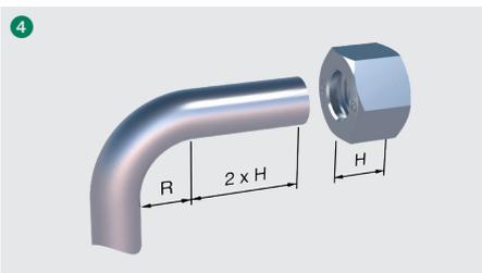
4 Die Länge der geraden Rohrenden von Rohrbögen muss mindestens der doppelten Länge der Überwurfmutter entsprechen.
