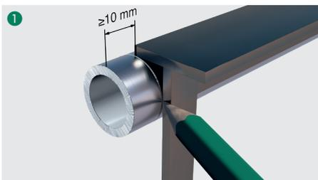
1 Sägen Sie das Rohrende in einem rechten Winkel (90°) und mindestens 10 mm entfernt vom Trennschnitt des Herstellers / Lieferanten ab.
