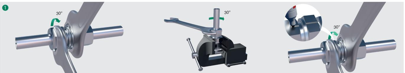
Schieben Sie das vormontierte Rohrende vorsichtig in den 24°-Konus des Verschraubungskörpers.
