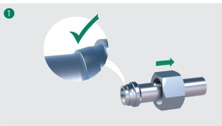
Lösen Sie die Überwurfmutter vollständig, um das Montageergebnis visuell zu überprüfen. Vor dem Schneidring muss ein deutlicher Materialaufwurf erkennbar sein und sollte die Schneidenstirnfläche mit ca. 80% bedecken. Unter Umständen ist es zu diesem Zeitpunkt noch möglich, den Schneidring auf dem Rohr (radial) zu drehen. Er lässt sich allerdings nicht mehr in Rohrrichtung (axial) verschieben.
