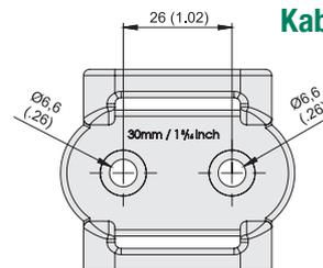
**Kabelbinder- / Spanngurt-Schelle
