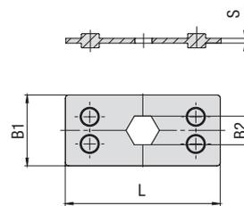
Aus flammhemmendem Kunststoff PPV0 gefertigt; geprüft und V0-klassifiziert entsprechend UL94
