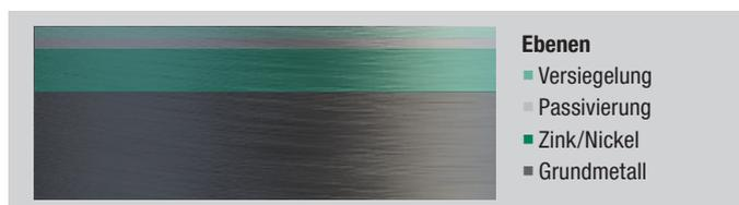
Sämtliche Bauteile der Produktreihe STAUFF Connect sind standardmäßig mit einer hochwertigen Zink/Nickel-Oberfläche ausgeführt.
