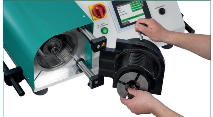
Spannbacken in die Maschine einsetzen und bis zum Anschlag nach hinten schieben.
