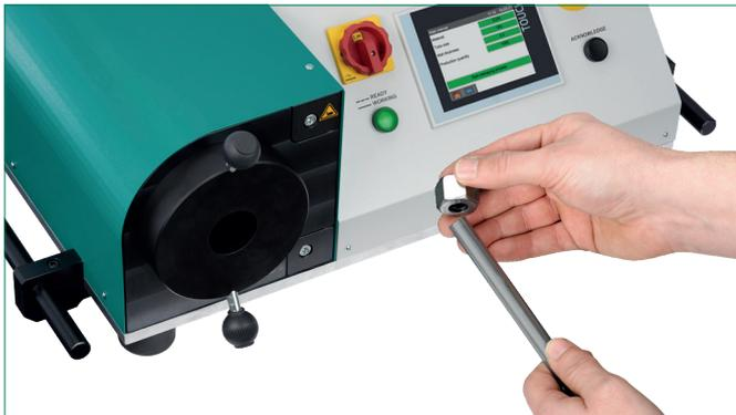
Überwurfmutter FI-M auf das Rohrende schieben. Bitte dabei die korrekte Ausrichtung beachten.
