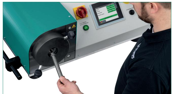
Umgeformtes Rohr entnehmen und visuell überprüfen.
