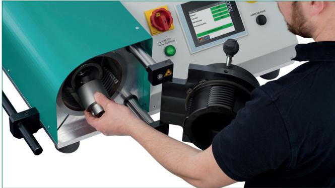
Formstutzen in den Bajonettverschluss der Maschine einsetzen.
