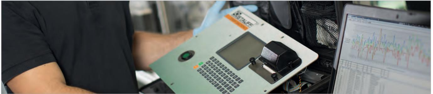
Mess-, Prüf-, Anzeige- und Analysegeräte aus der Produktgruppe STAUFF Diagtronics ermöglichen Anlagenbetreibern, Instandhaltern und Wartungsfachkräften die Ermittlung und Überwachung der wichtigsten Parameter in der Mobil- und Industriehydraulik: Betriebsdruck, Spitzendruck, Differenzdruck, Medientemperatur, Durchflussmenge, Drehzahl, Verschmutzung und vieles mehr.
